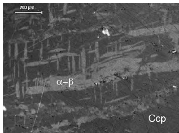
Abb. 6: Auflichtaufnahme bei leicht gekreuzten Nicols. Deutlich zu erkennen sind hier die „oleanderblattformigen“ a-b Umwandlungslamellen (α-β) im Chalkopyrit (Ccp). Probe HP2.
